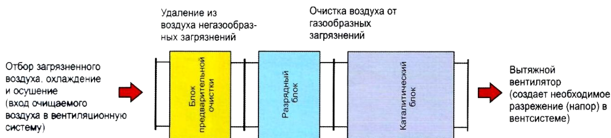
Рисунок 31 — Установка газоразрядно-каталитической очистки [55]
