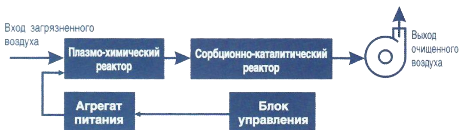
Рисунок 30 — Пример сорбционно-плазмо-каталитической очистки [67]
