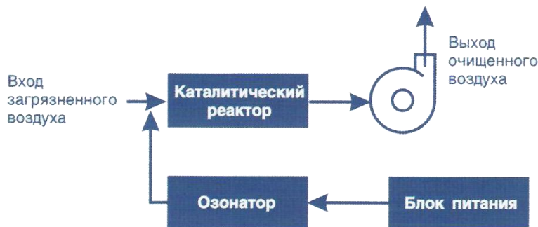
Рисунок 29 — Пример озон-каталитической очистки [67]
