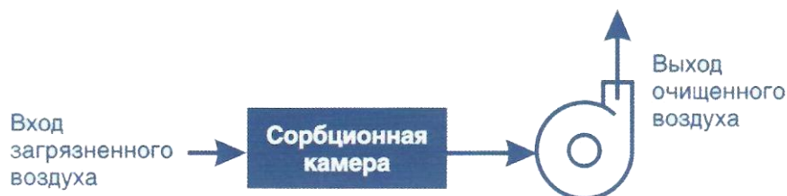
Рисунок 23 — Пример сорбционной очистки воздуха [67]
